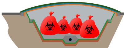
RELLENO DE SEGURIDAD
